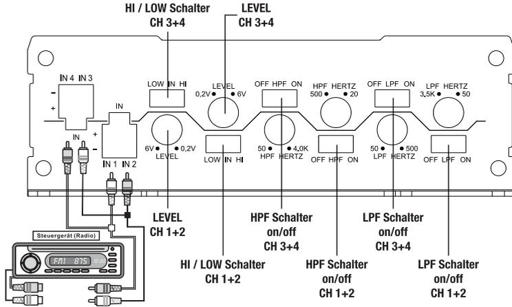
Der X SERIES Verstärker besitzt Stecker, an welche Cinchkabel mit den Vorverstärker-Ausgängen des Steuergerätes adaptiert werden können. Wenn dies nicht möglich ist (meist bei einem Originalradio, OEM) können die Lautsprecheranschlüsse des Autoradios direkt auf die Eingänge des Verstärkers angeschlossen werden. Der Input Mode muss hierbei auf "HI" umgeschaltet werden.
